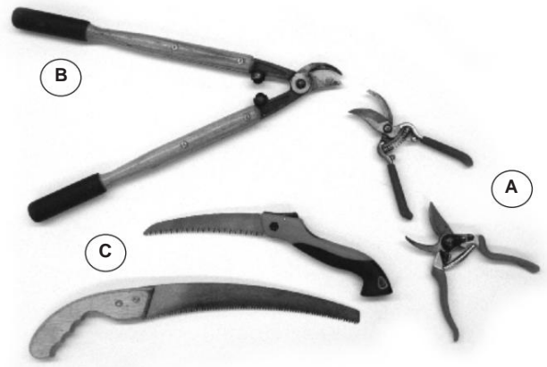
Rajah 4. Alat yang digunakan untuk memangkas tumbuhan ber kayu termasuk (a) gunting tangan pintasan, (b) loppers, dan (c) gergaji tangan. Foto oleh Robert Tripepi.
