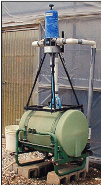
Rajah 4. Kadar aliran maksimum untuk penyuntik DosMatic berjulat daripada kurang daripada 1 gpm hingga 100 gpm dengan nisbah dari 1:10 hingga 1:4000 pada pelbagai model. Nisbah suntikan boleh dilaraskan semasa digunakan. Pelbagai gabungan aliran air dan nisbah suntikan boleh ditampung, contohnya, aliran rendah dan suntikan rendah, aliran rendah dan suntikan tinggi kepada aliran tinggi dan suntikan rendah, dan aliran tinggi dan suntikan tinggi.
